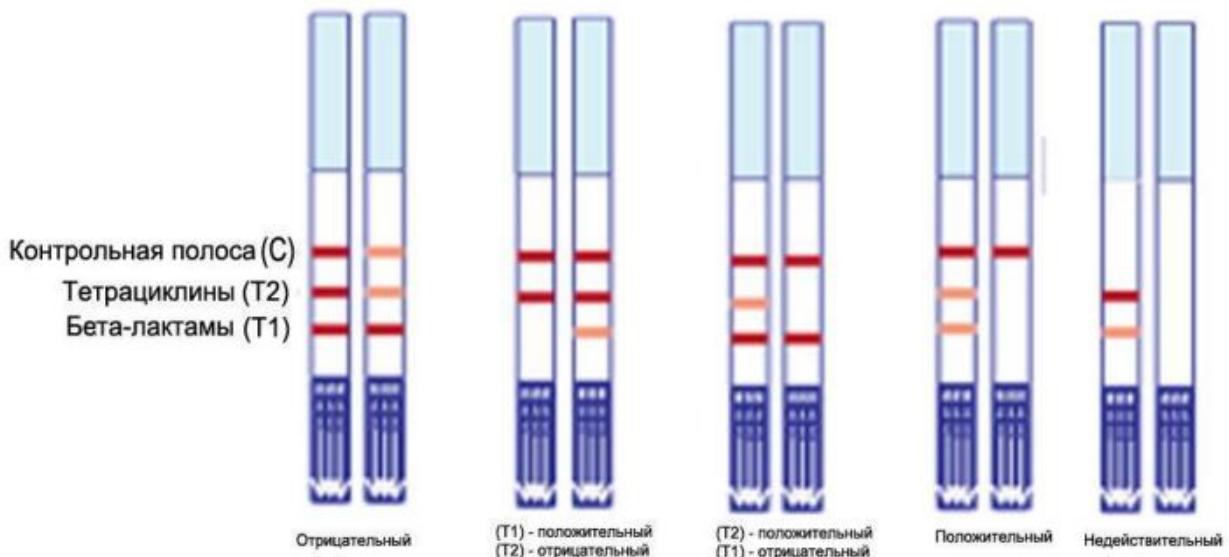
**Отрицательный результат (-):** контрольная линия (C) окрашена красным; соответствующая своему антибиотику тестовая линия (T1, T2) окрашена красным ярче контрольной линии (C) или имеет одинаковую интенсивность окрашивания с контрольной линией (C). Это означает, что образец не содержит антибиотики вообще, или содержит их меньше предела обнаружения теста-набора (см. Таблицу 1).
