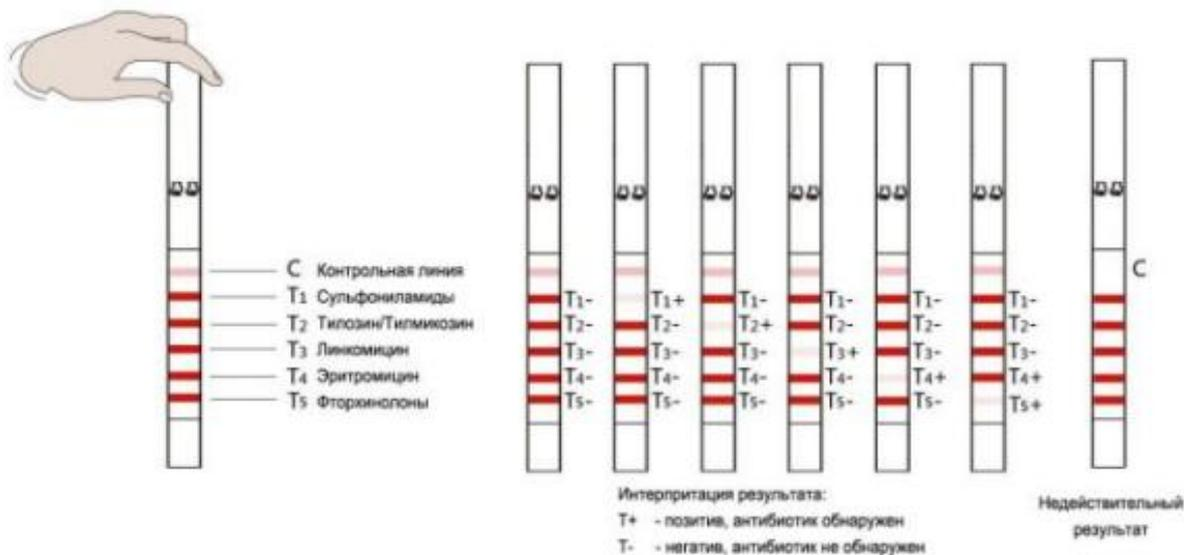
**Отрицательный результат (-):** контрольная линия (С) окрашена красным; соответствующая своему антибиотику тестовая линия (Т1 ... Т5) окрашена красным ярче контрольной линии (С) или имеет одинаковую интенсивность окрашивания с контрольной линией (С). Это означает, что образец не содержит антибиотика вообще, или содержит их меньше предела обнаружения тест-набора (см. Таблицу 1).
